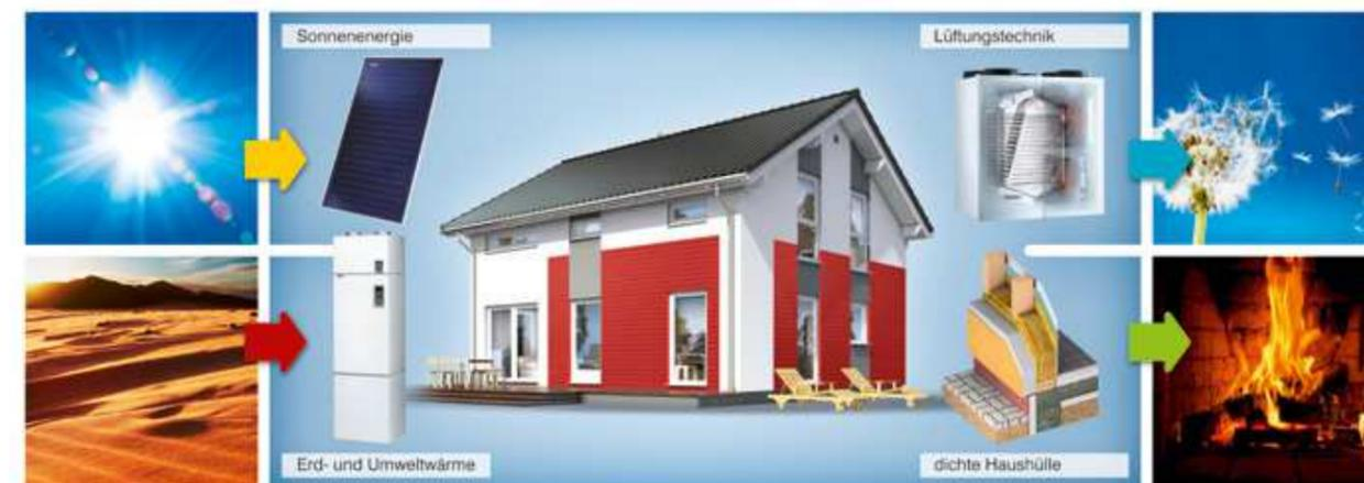
Erde, Wasser und Luft sind sehr gute Speichermedien für die Sonnenenergie, die wir zum Heizen nutzen können. Für jede Quelle gibt es entsprechende Wärmepumpen.
