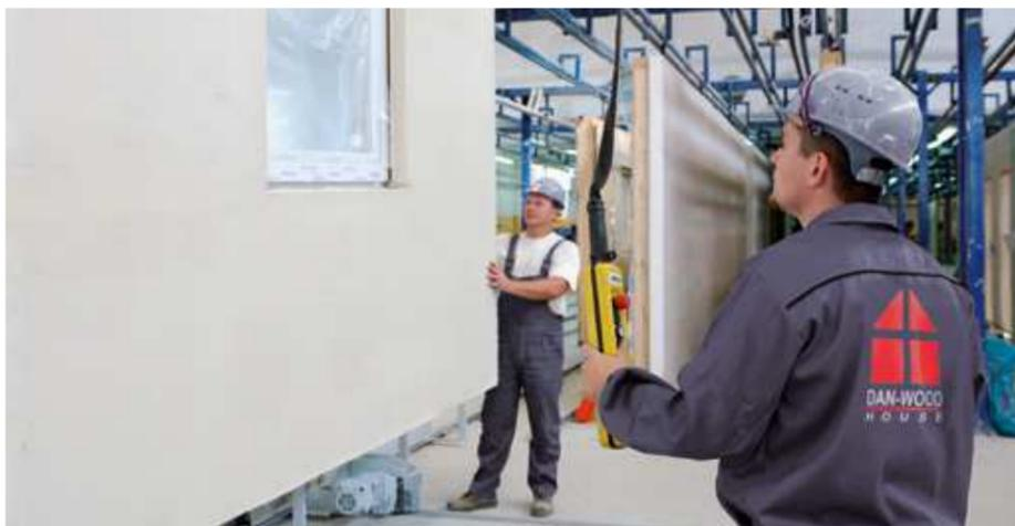
Die Wände werden in der Fabrik vorgefertigt...
